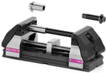
Figura: 970230101 Extensión de suministro estándar: Tornillo de banco para máquina, incluyendo mordazas de sujeción con tracción hacia abajo, tuerca de sujeción corta y larga, husillo de tracción corto y largo
