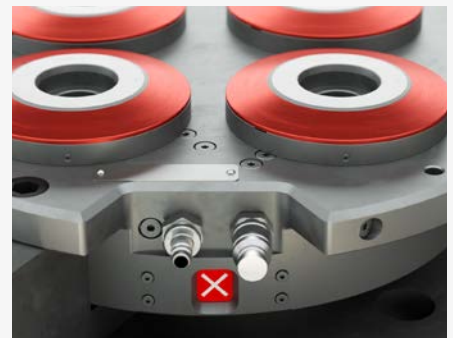
Le voyant passe au rouge lors du desserrage jusqu'à ce qu'un contrôle positif de serrage soit à nouveau effectué.
