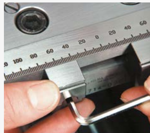
2. Außenkanten der Einsätze ca. 2mm unterhalb Fertigmaß einstellen.
