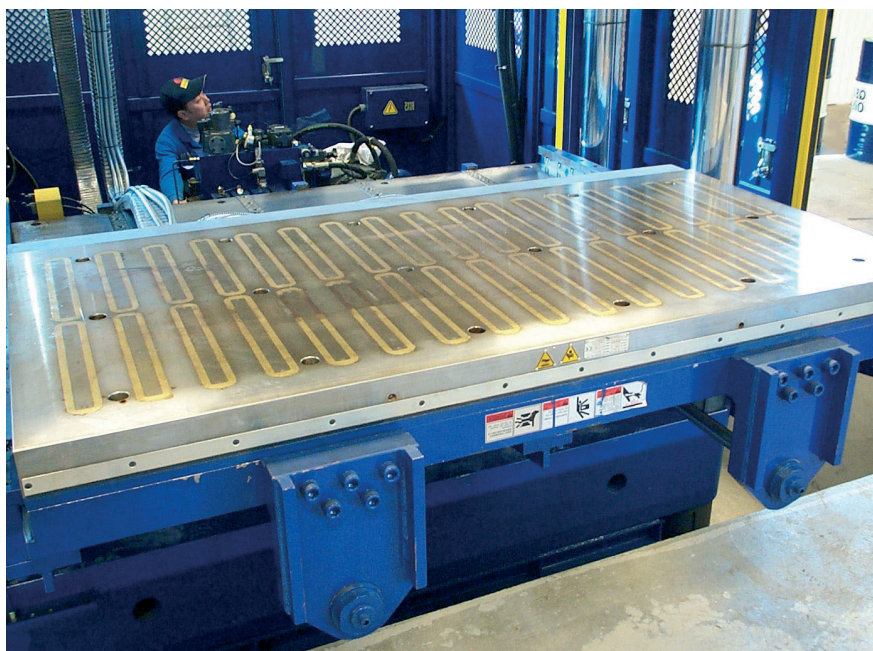
Sistema de sujeción magnética en una prensa vertical para temperaturas de hasta 240 °C
