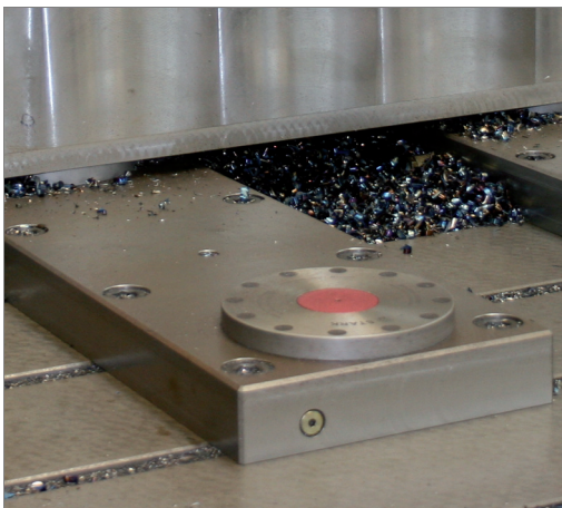
SPEEDY classic 3 Schnellspannverschlüsse in Aufnahmeplatte für Winkel eingebaut.
